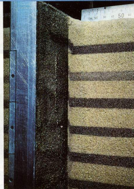
写真-5 アンカー表面に見 られたせん断層
